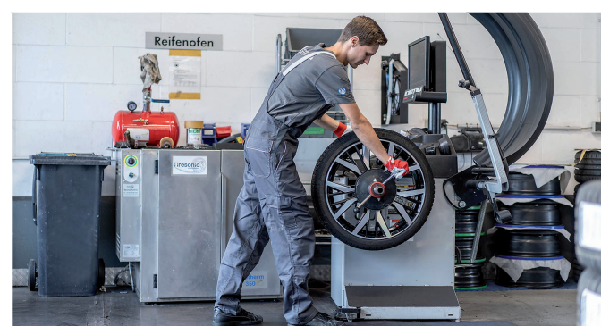
Im Reifenofen wird der Reifen weicher und kann ohne Schäden auf neue Felgen aufgezogen werden. Foto: Autohaus Diether
