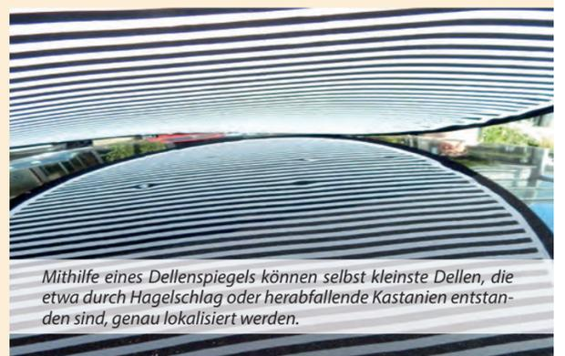
Mithilfe eines Dellen spiegels können selbst kleinste Dellen, die etwa durch Hagelschlag oder herabfallende Kastanien entstanden sind, genau lokalisiert werden.
